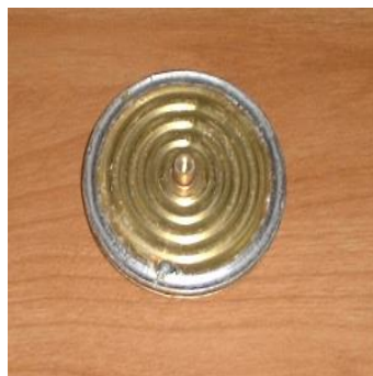
د تودوخي تنظيمونکي آله، ترموستات
