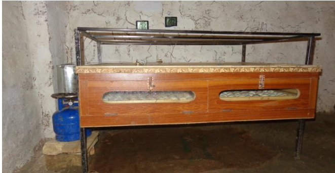
په مصنوعي ډول د چرگورو ایستلو کازي ماشین (د ۴۰۰ هگیو په ظرفیت سره)
