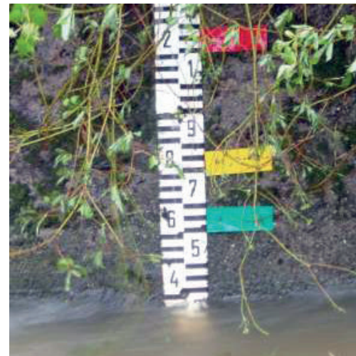
Vodoměrná lat s vyznačením stavů odpovídajících jednotlivým stupňům povodňové aktivity.
