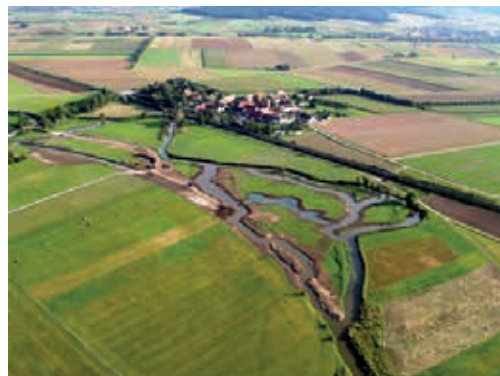
Revitalizace toku řeky v Německu je příklad přírodě blízkého protipovodňového opatření.
